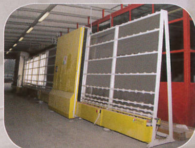
Produzione vetrocamera linea automatica 2000 x 2800
