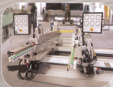
Molatrice bilaterale a struttura variabile 210 ÷ 2500
