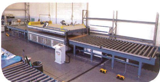
Stratifica forno di assemblaggio pvc 2100 x 4500 (capacità: 200 mq / giorno)
