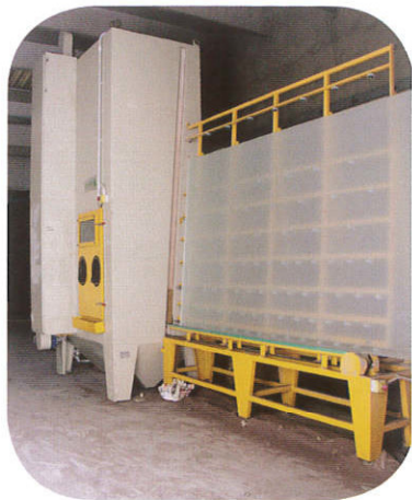
Sabbiatura sabbiatrice verticale automatica 2500 x 6000
