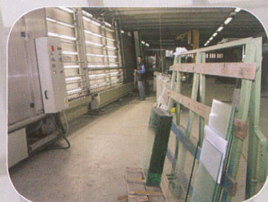
Produzione vetrocamera linea automatica 2550 x 4200
